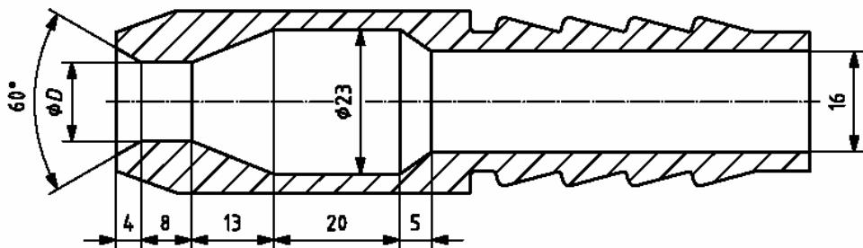
$D = 6.3$ , 用于关于防水等级 5 和 6K 的试验 $D = 12.5$ , 用于关于防水等级 6 的试验
